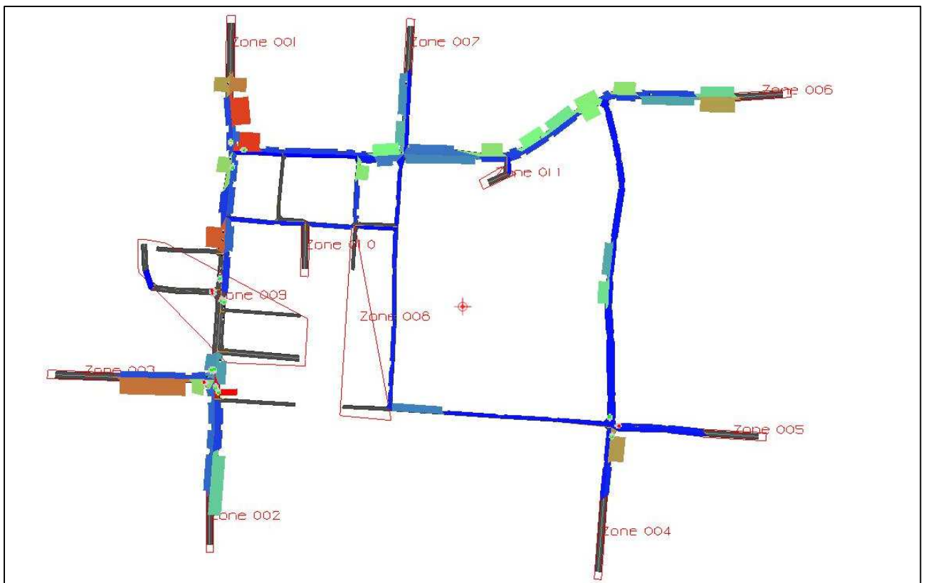
Stato di fatto SDF: Flussi veicolari (sopra) e densità (sotto) (blu valore minimo, verde medio, rosso massimo)
